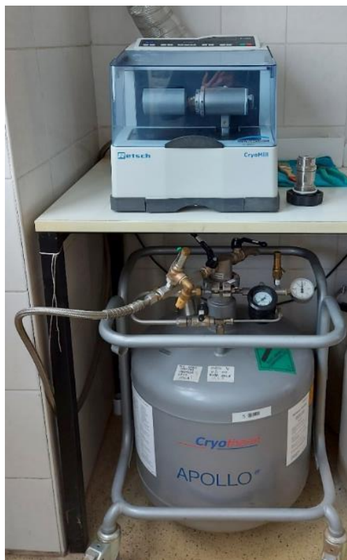
Slika 2. Kuglični mlin sa spremnikom dušika (vlastita fotografija)
