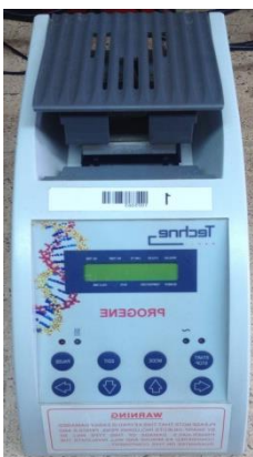
Slika 4. Uređaj za PCR (PCR-termoblok)
