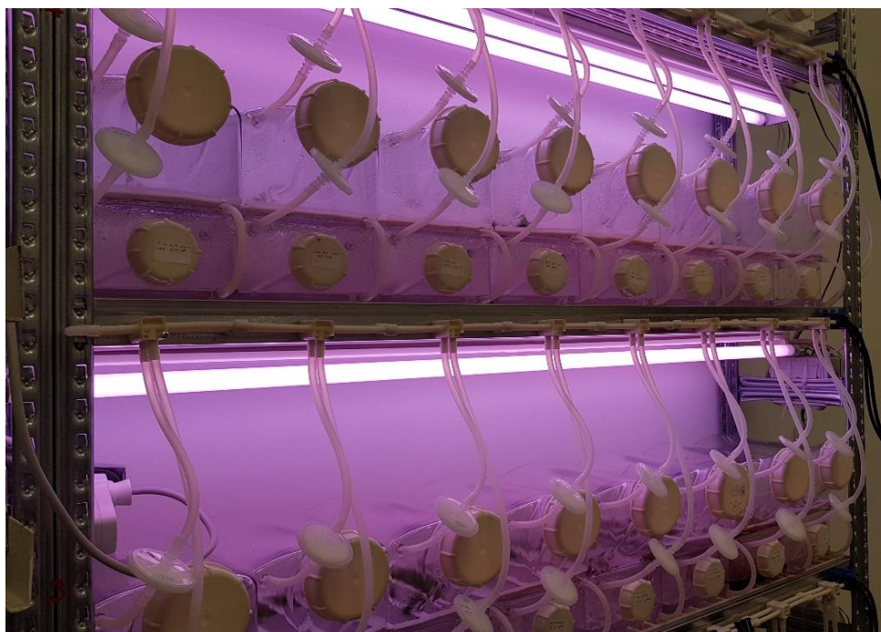
Slika 11. Suvremeni imerzni sustav bioreaktora TIB/TIS, Laboratorij za voćarstvo – FAZOS (Foto: Bošnjak, 2019.)
