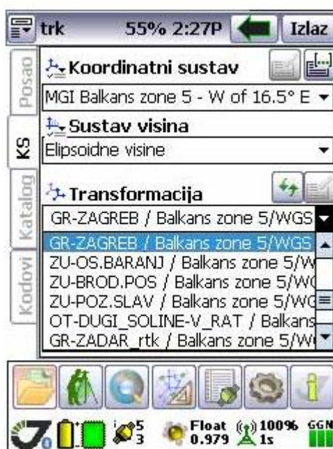
Slika 6. Prikaz displaya trk sustava - postavljanje koordinatnog sustava
