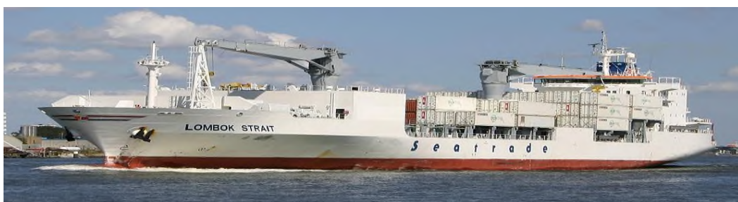
Slika 24. Brod za transport hlađenog tereta Izvor: ( https://en.wikipedia.org/wiki/Reefer_ship )
