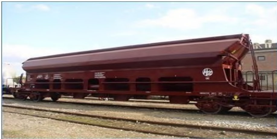
Slika 33. Vagon za transport žitarica serije Tads – z Izvor: (Breznik, 2015.)
