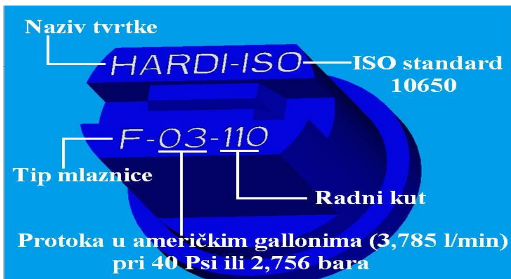
Slika 3: Način označavanja mlaznica prema ISO 10625 standardu
