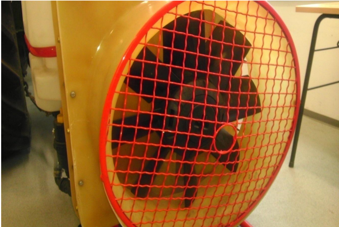
Slika 2. Aksijalni ventilator raspršivača Agromehanika
