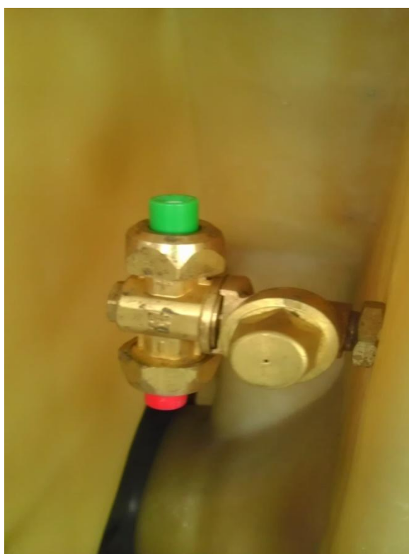
Slika 7. Nosači za mlaznice na raspršivaču Agromehanika 400EN
