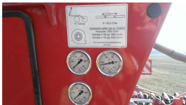
Slika 15. Instrumenti za očitavanje veličina rada ventilatora
