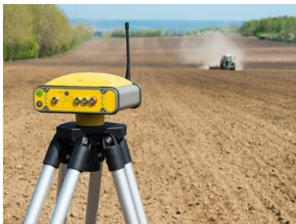
Slika 9. Bazna stanica za RTK metodu
