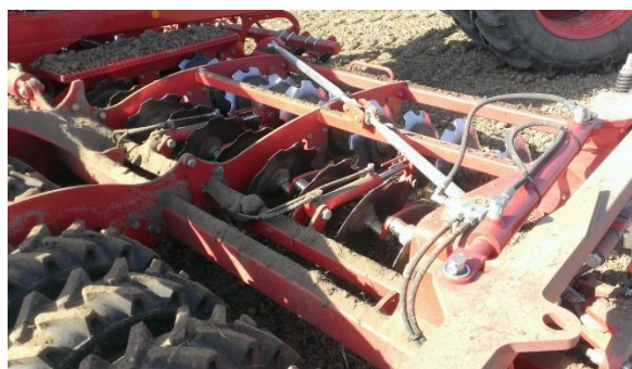
Slika 18. Sistem diskova koji vrši usitnjavanje
