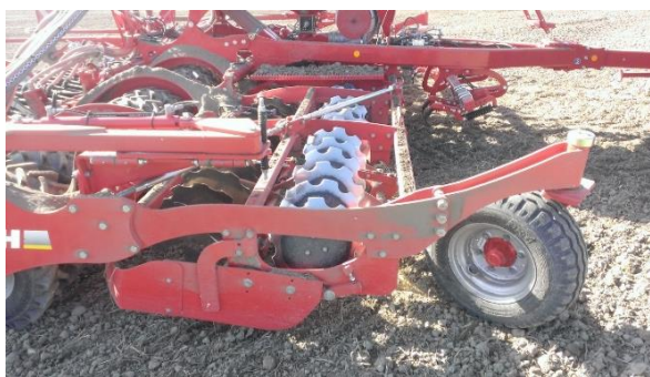
Slika 18. Sistem diskova koji vrši usitnjavanje
