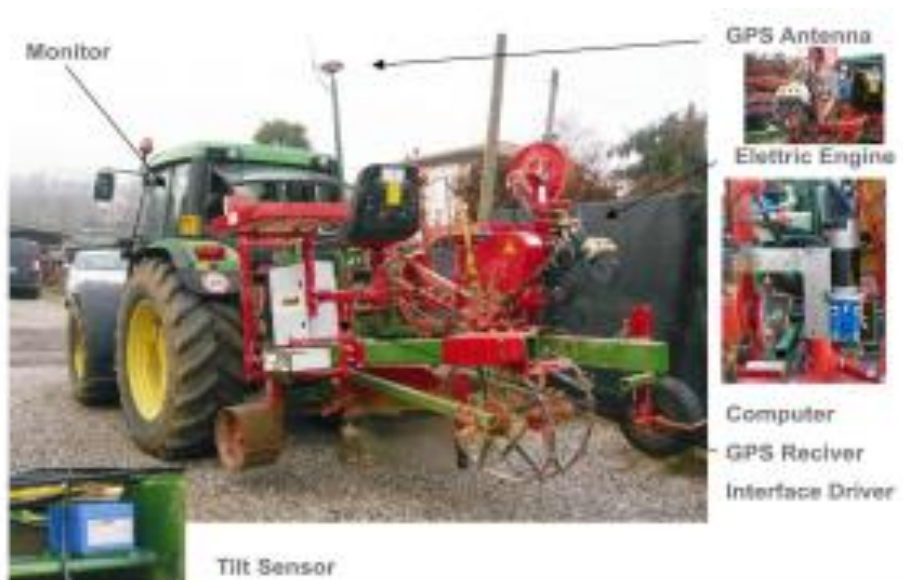
Slika 45. Komponente GPS sustava za navođenje
