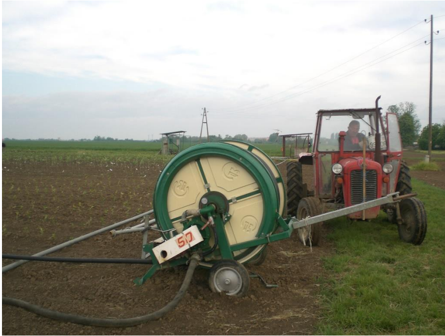
Slika 3. Tifon sustav za navodnjavanje
