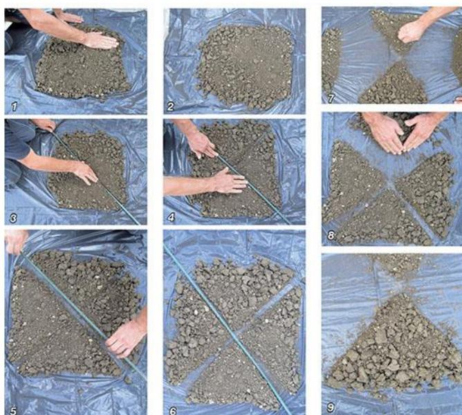
Slika 3. Priprema prosječnog uzorka „četvrtanjem“
