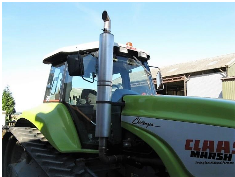
Slika 3. Ispušna cijev na traktoru (Izvor: http://www.eurotrackltd.com/content/uploads/2013/10/Stainless-muffler-on-Challenger-55.jpg )
