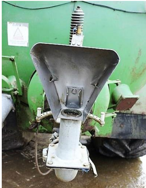
Slika 5. Raspršivač gnojovke od nehrđajućeg čelika
