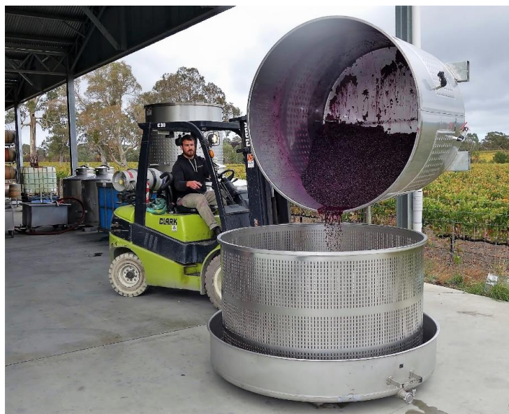
Slika 12. Nehrđajući spremnik i cjedilo za grožđe
