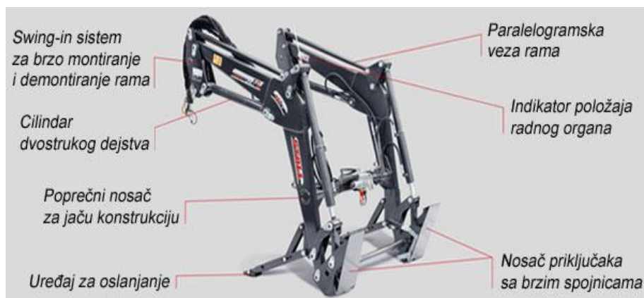
Slika 30. Konzola prednjeg traktorskog utovarivača (Izvor: link 12.)
