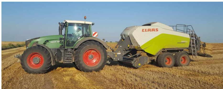
Slika 14. Prešanje slame u kvadratne bale (Izvor: vlastita fotografija)
