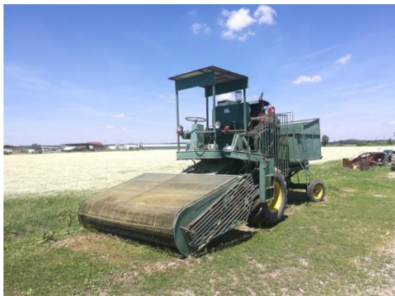
Slika 4. Samohodni berač kamilice (detaljan prikaz) ( Foto original )
