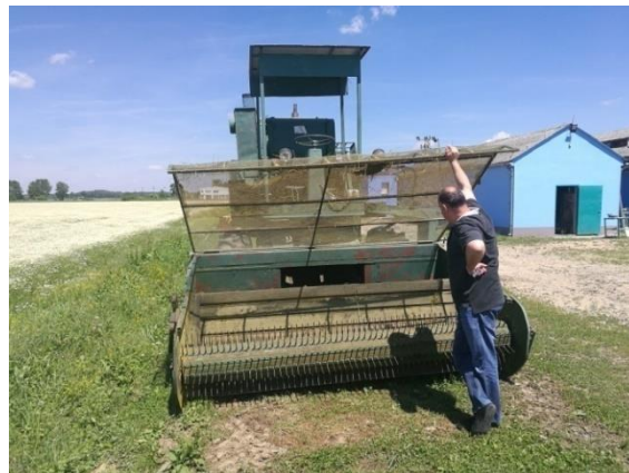
Slika 4. Samohodni berač kamilice (detaljan prikaz) ( Foto original )
