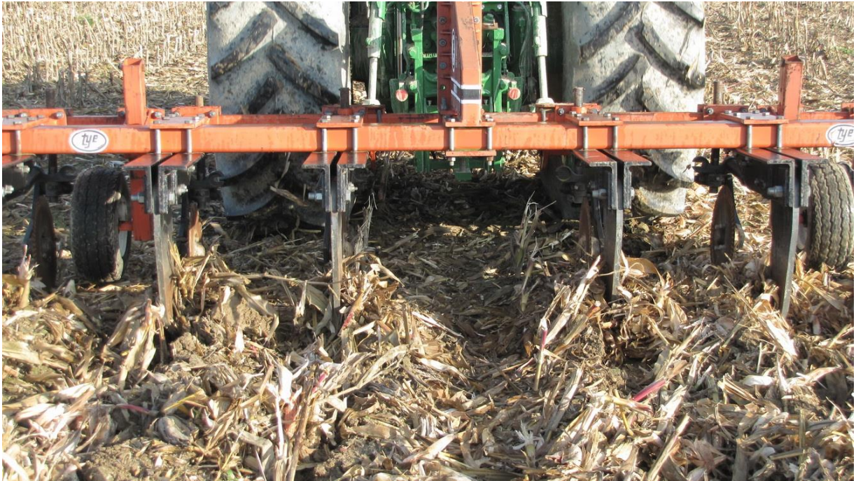
Slika 3. Obrada tla rahljenjem (izvor: Jug, D.)
