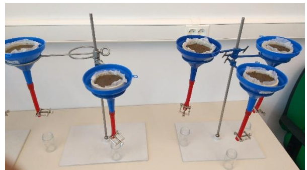
Slika 24. Ispiranje nematoda iz tla metodom Baermannovih lijevaka Foto: Poturiček L.
