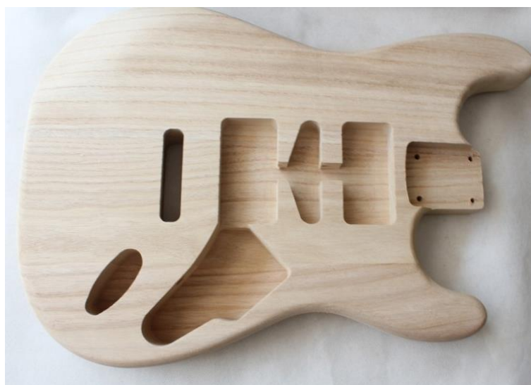
Slika 4. Izrada glazbenog instrumenta od paulovnije
