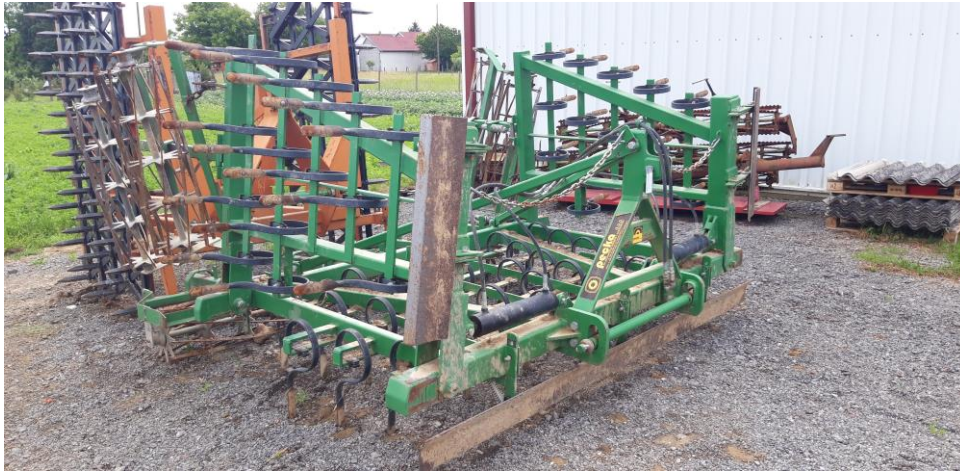
Slika 2. Sjetvospremač Pecka (Šmider, 2020.)
