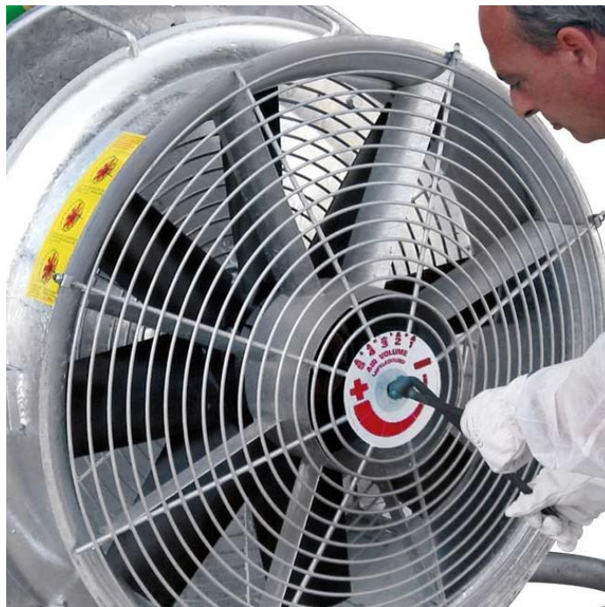
Slika 7. Ventilatorski sustav raspršivača Tifone VENTO - 1000
