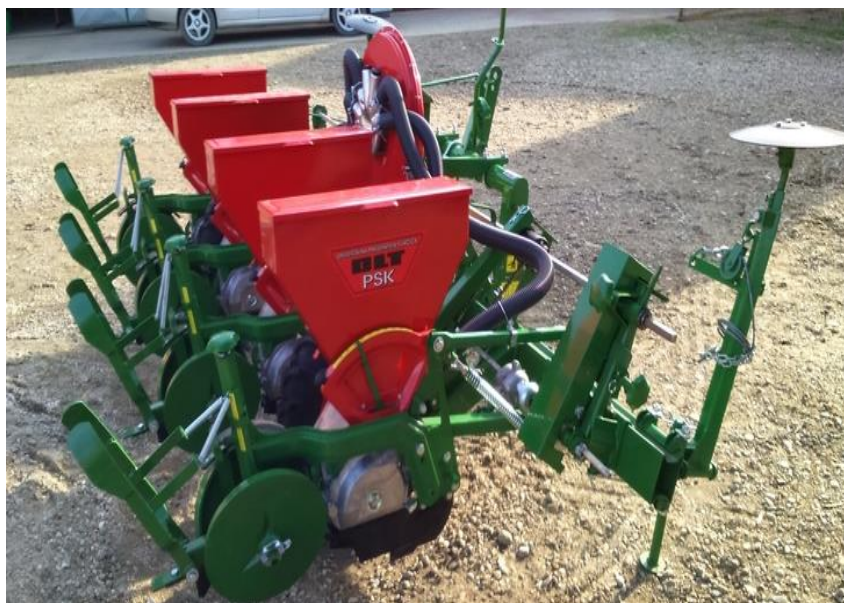
Slika 6. Pneumatska sijačica PSK4
