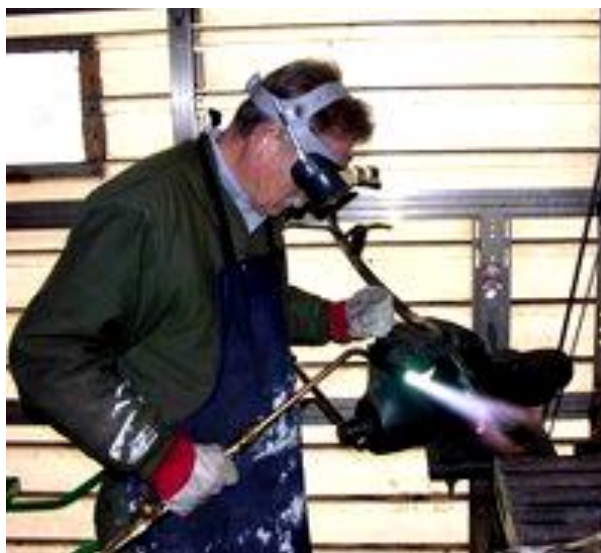
Slika 14: Zavarivanje plinskim plamenom (Izvor: Kopic, 2007.)
