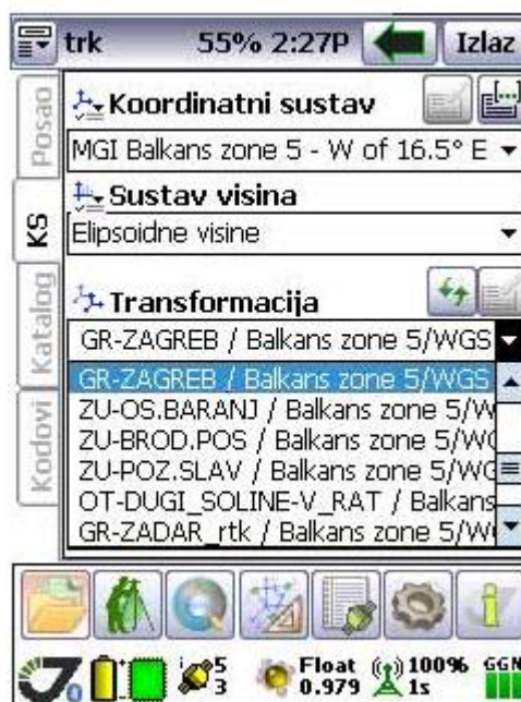
Slika 6. Prikaz displaya trk sustava - postavljanje koordinatnog sustava
