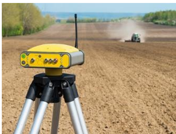
Slika 9. Bazna stanica za RTK metodu
