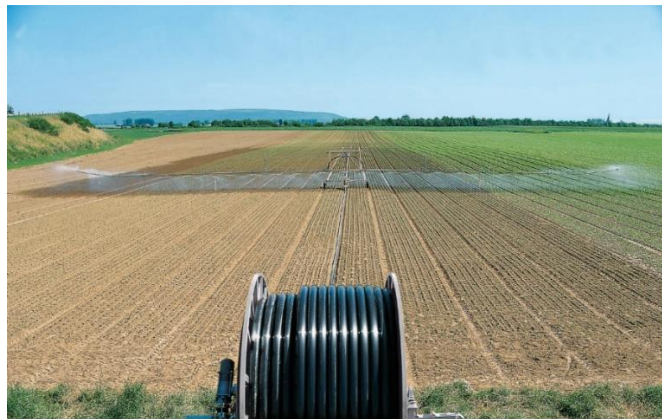
Slika 6. Kišno krilo i kotur (Preuzeto sa: www.bauer.com )
