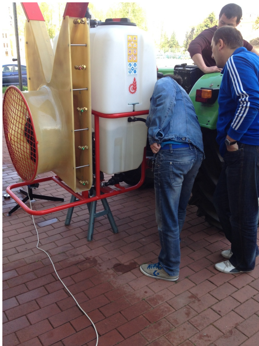
Slika 16. Pregled i kontrola ispravnosti raspršivača Agromehanika 500 EN
