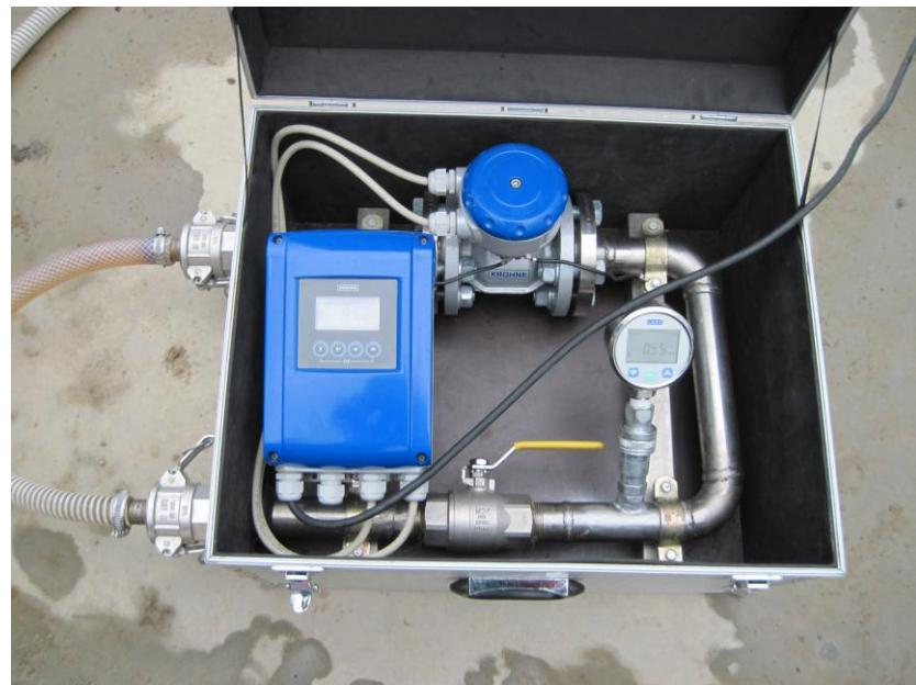
Slika 14. Uređaj za kontrolu protoka crpke *Krohne*
