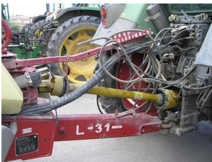
Slika 10. Pravilno postavljena zaštita priključnog vratila
