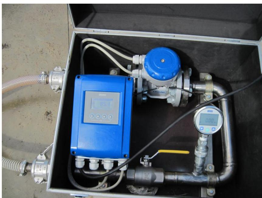
Slika 15. Uređaj za kontrolu protoka crpke *Krohne*
