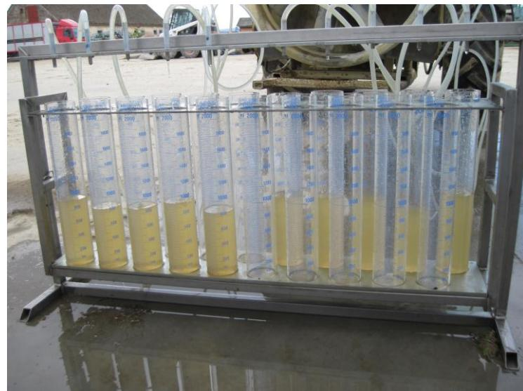
Slika 16. Testiranje protoka mlaznica i raspodjele tekućine
