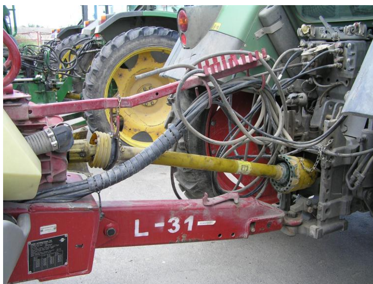
Slika 10. Pravilno postavljena zaštita priključnog vratila
