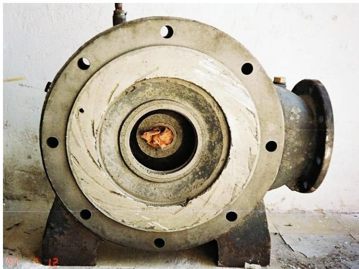
Slika 18. Erozijska korozija brtvene površine crpke (Izvor: <http://belzona.hr/tag/erozija/>)
