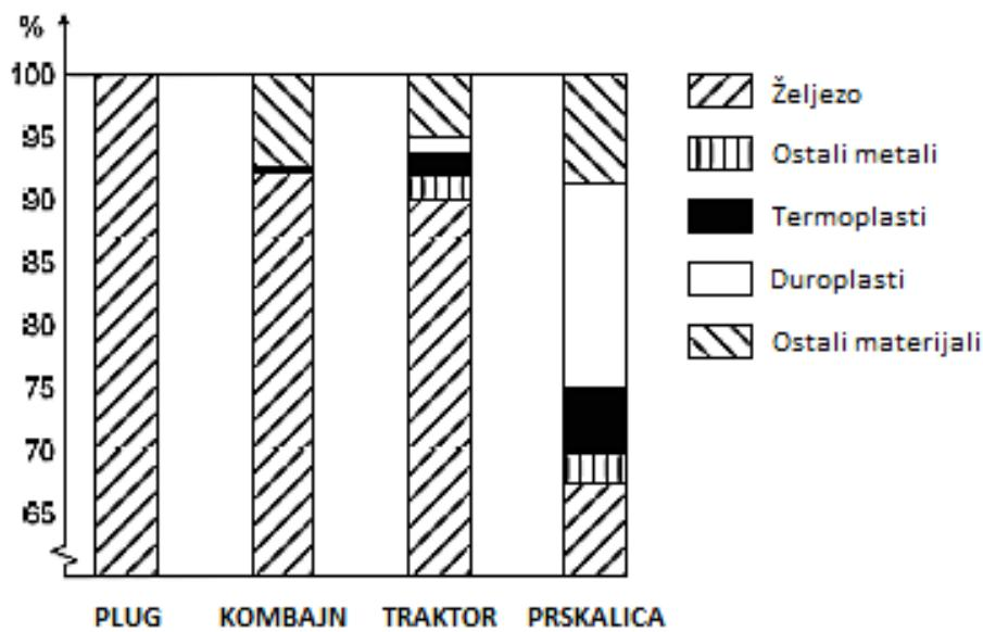
Slika 23. Zastupljenost konstrukcijskih materijala kod nekih poljoprivrednih strojeva
