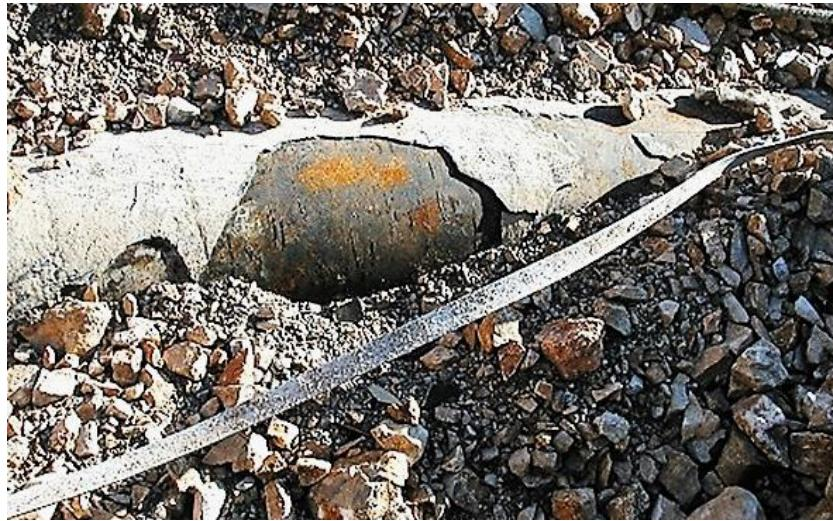
Slika 22. Korozija podzemnog spremnika
