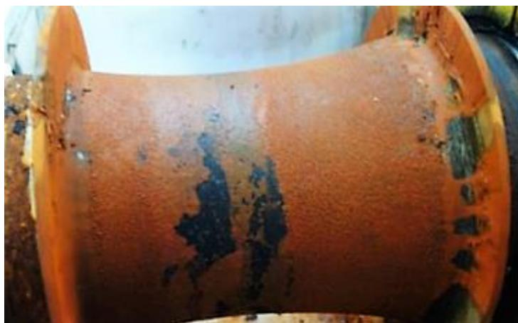
Slika 17. Korozijujski zamor dijela osovine
