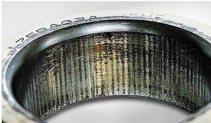
Slika 20. Tarna korozija vanjskog prstena kotrljajućeg ležaja
