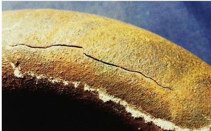
Slika 16. Primjer oštećenja uslijed napetosne korozije (Izvor: Horvat i sur., 2011.)
