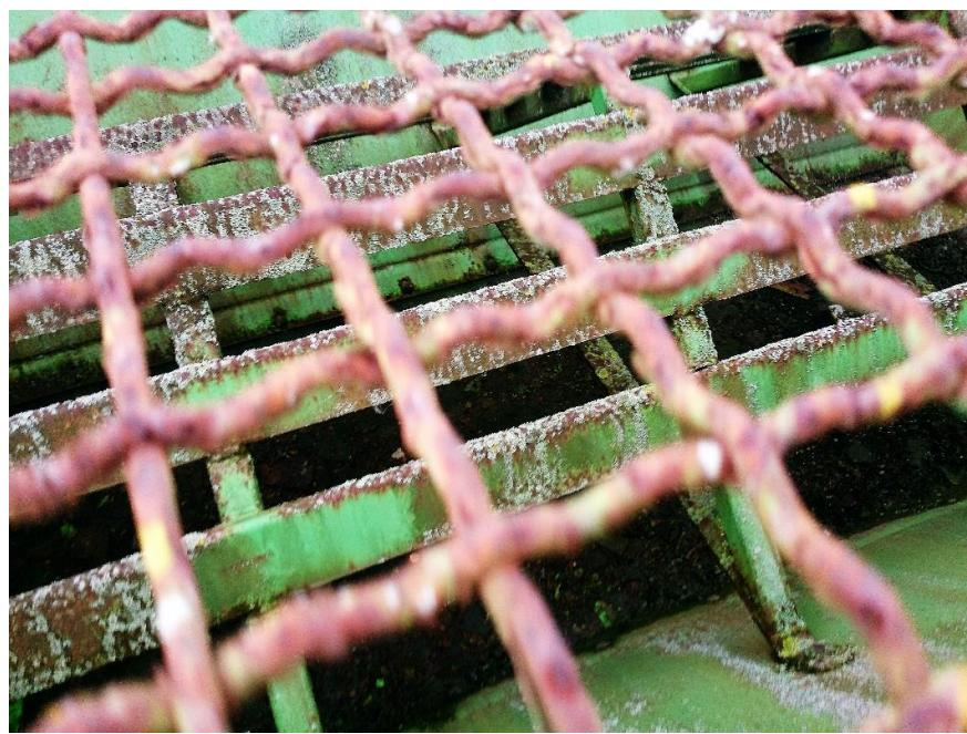
Slika 38. Rešetke spremnika rasipača mineralnog gnojiva (foto: I. Andrić)
