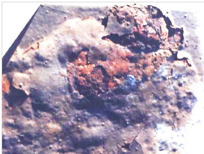
Slika 12. Površina materijala napadnutog potpovršinskom korozijom (Jelić Mrčelić, 2010.)
