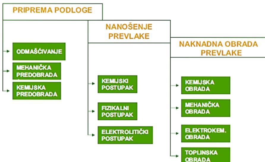
Slika 26. Postupci pripreme podloge, nanošenja i obrade prevlake
