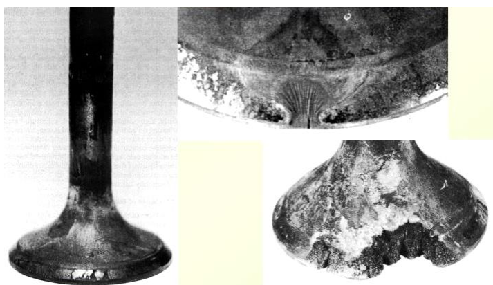
Slika 4. Oštećenja sjedišta ventila zbog kemijske korozije (Medica, 2010.)
