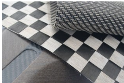
Slika 6 - Hibridna vlakna karbon-lan[5]
