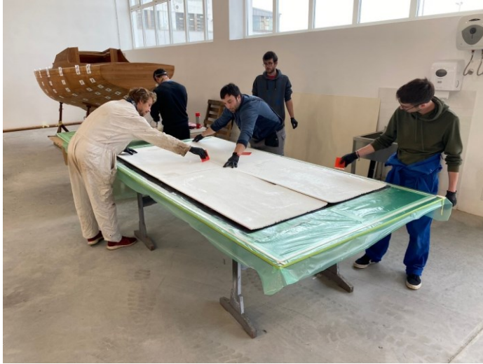
Slika 9 Prikaz procesa vacuum bagging-a
