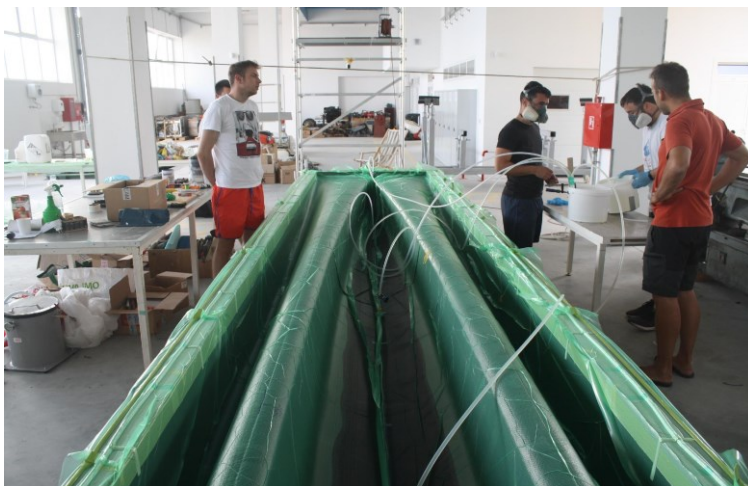
Slika 10 - Primjer gradnje plovila vakuumskom infuzijom u kalupu
