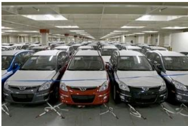
Slika 7 - Prikaz učvršćivanja automobila na RO-RO brodu
