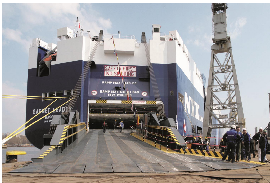
Slika 9 - prikaz otklonjene rampe PCC broda
