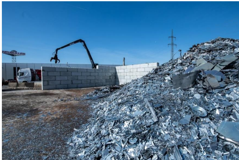
Slika 4. Primjer željeznog otpada E8 kvalitete
