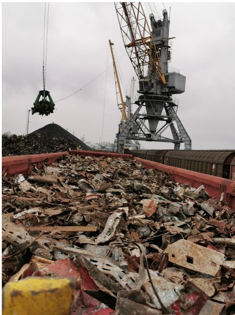
Slika 32. Direktni istovar iz vagona na skladište
