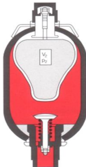
Slika 18. Membranski i akumultor s mijehom
