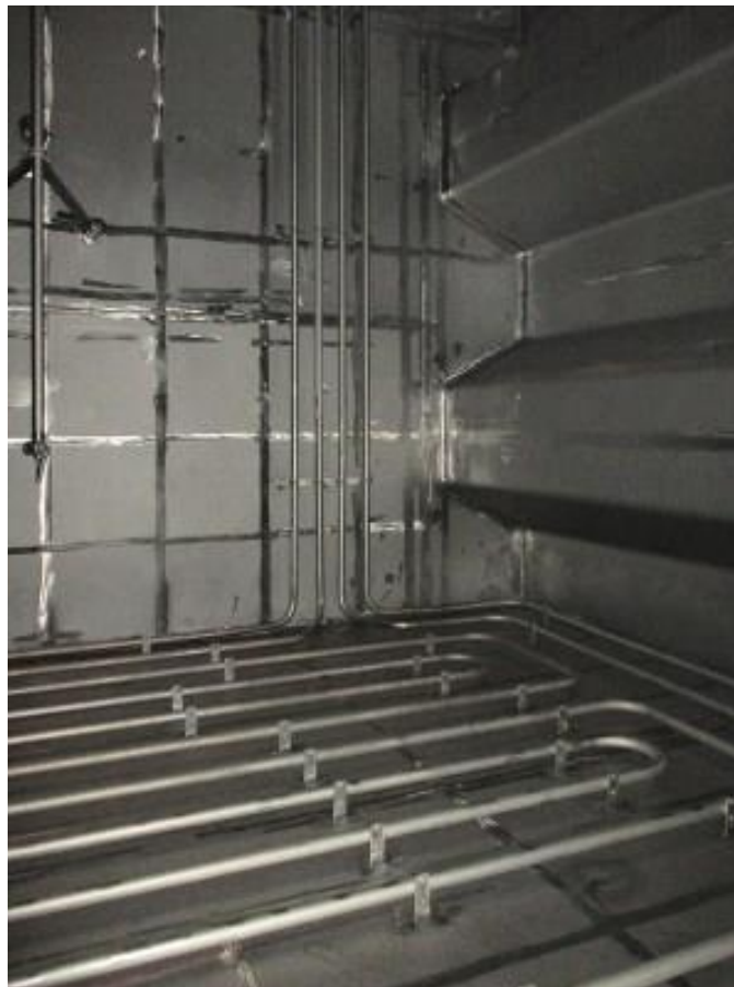
Slika 10. Sustav serpentina unutar tanka tereta
