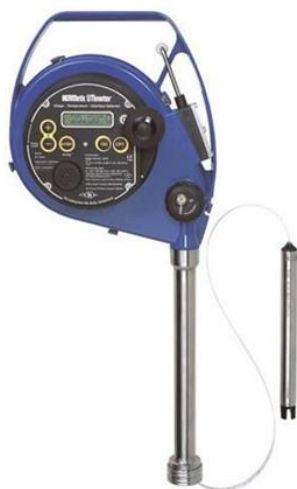
Slika 9. Ullage Temperature Interface (UTI) uređaj
