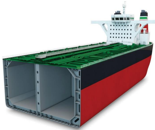
Slika 5. Presjek tankera s dvostrukom oplatom
