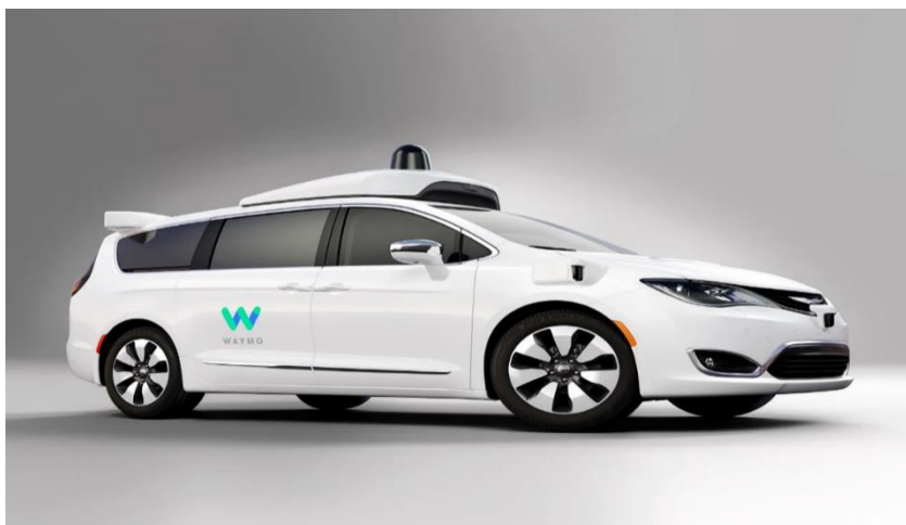
Slika 7. Chrysler Pacifica Hybrid autonomno vozilo razvijeno od tvrtke Waymo
