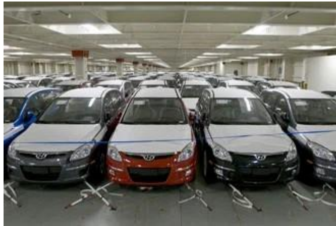
Slika 7 - Prikaz učvrščivanja automobila na RO-RO brodu
