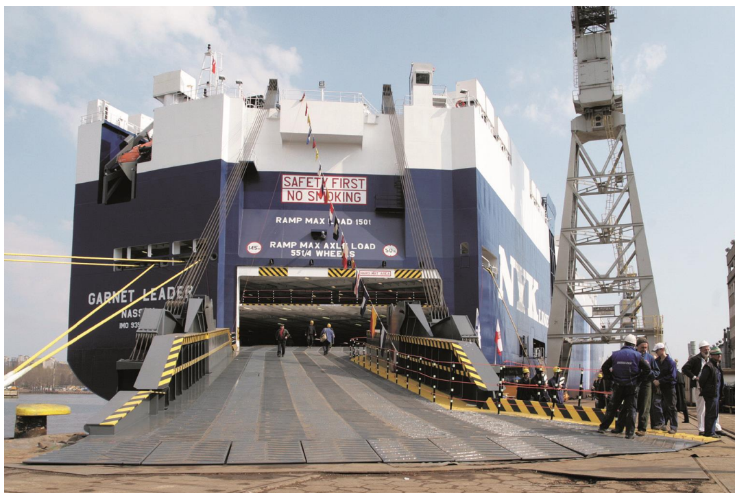
Slika 9 - prikaz otklonjene rampe PCC broda
