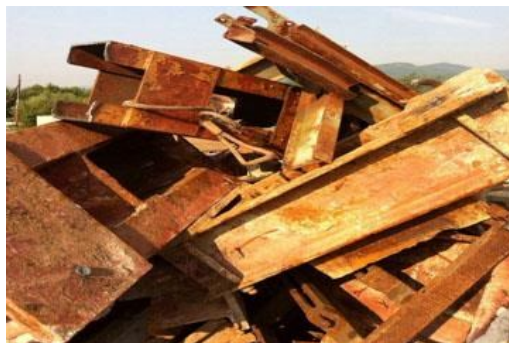
Slika 2. Primjer otpadnog željeza E3 kvalitete
