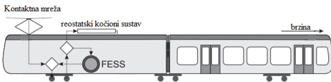
Slika 31 - Regenerativno kočenje unutar željezničkog prometa
