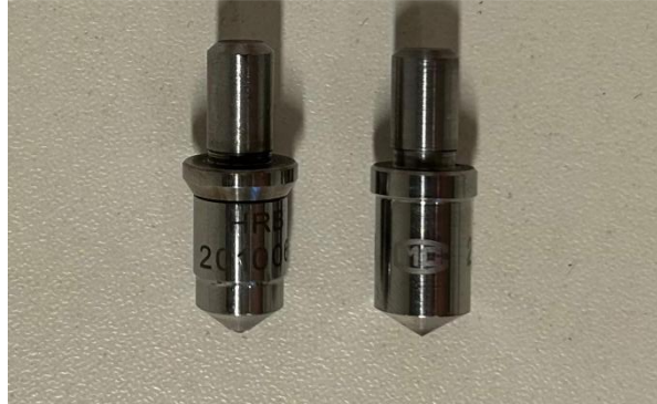
Slika 16. Penetratori za HRC i HRB metodu.
