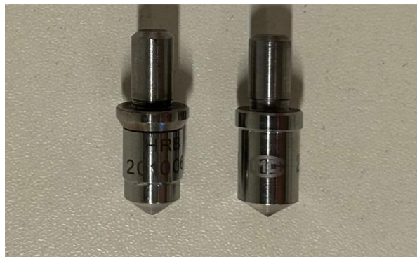
Slika 16. Penetratori za HRC i HRB metodu.
