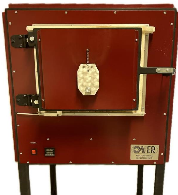
Slika 13. Peć proizvođača “OVER industrijska elektronika” kontrolora “XMTG-808”.
