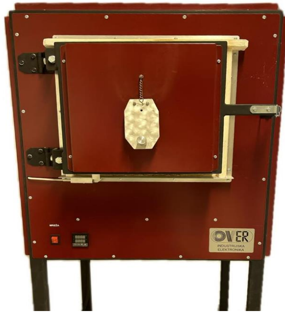
Slika 13. Peć proizvođača “OVER industrijska elektronika” kontrolora “XMTG-808”.
