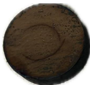
Slika 21. Pukotina na uzorku "Kaljenje vodom".
