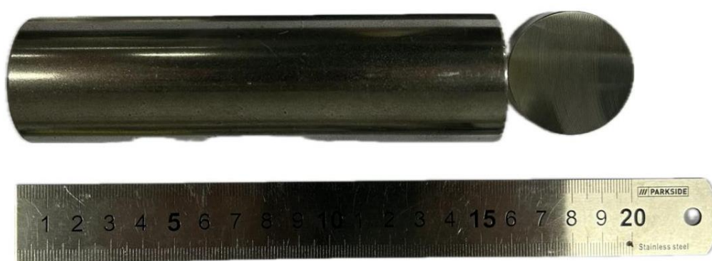
Slika 12. Uzorak šipke debljine 11mm i promjera 40 mm.
