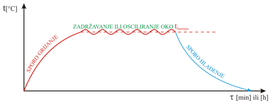
Slika 6. Dijagram toplinske obrade žarenja [11].
