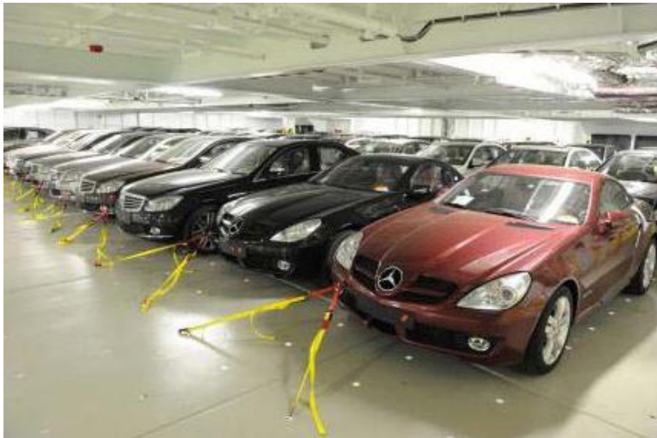
Slika 14. Prikaz osiguranja vozila žičanim načinom [6]
