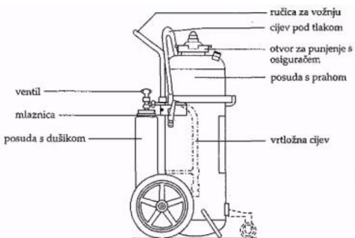
**Slika 5. Uređaj za gašenje požara prahom [1]**
