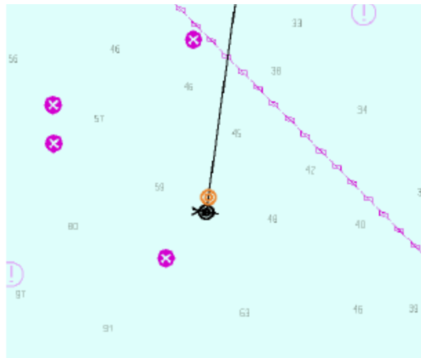
Slika 36. Pozicije primarnog i sekundarnog GPS-a su različite [7]
