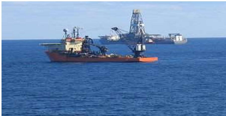
**Slika 1. Brod s sustavom dinamičkog pozicioniranja [15]**
