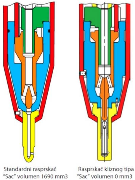
**Slika 8. Prikaz razlike novog kliznog rasprskača i standardnog rasprskača za motor MAN B&W K98MC [5]**
