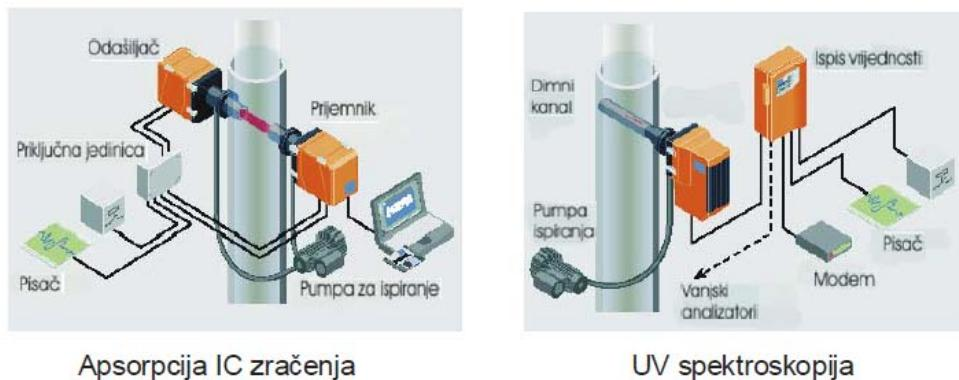
Slika 17. Analizator za kontinuirano mjerena emisije štetnih plinova [9]
