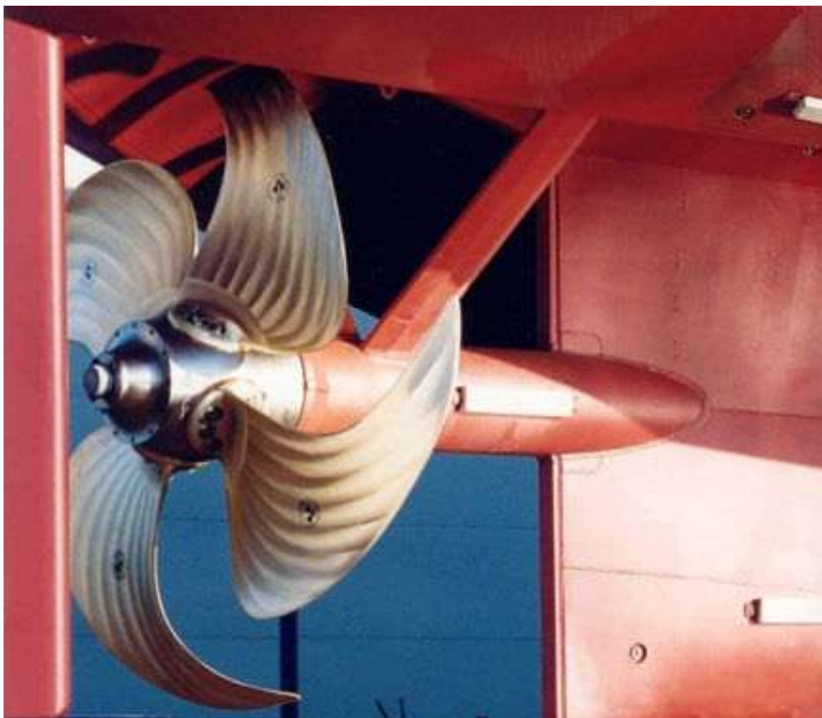
Slika 3. Brodski vijak s promjenjivim usponom krila [5]
