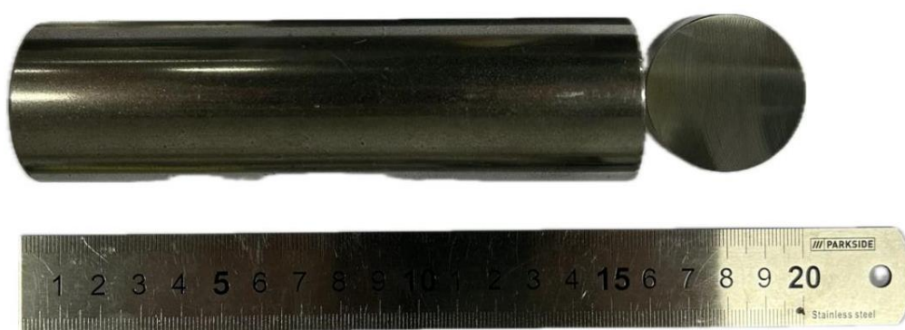
Slika 12. Uzorak šipke debljine 11mm i promjera 40 mm.
