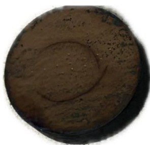
Slika 21. Pukotina na uzorku "Kaljenje vodom".
