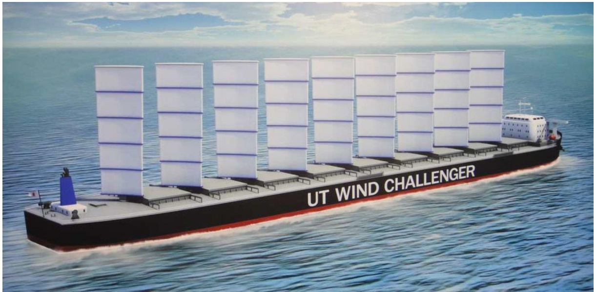
Slika 26. Koncept broda sa solarnim i vjetropogonom [preuzeto sa www.ecomarinepower.com ]
