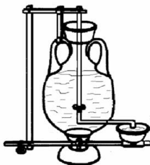
Slika 3. Heronov uređaj za regulaciju punjenja [5]
