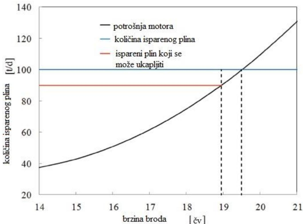
**Slika 11. Ovisnost brzine broda i količine isparenog plina [3]**
