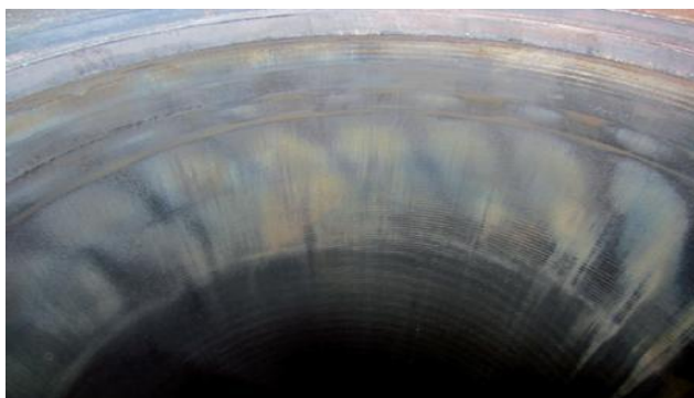
Slika 23. Stanje stjenke cilindra i pojava hladne korozije
