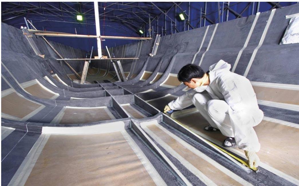
Slika 50. Kompozitna konstrukcija broskog trupa [30]
